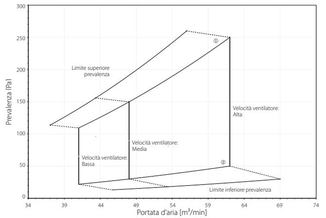
① Limite superiore della prevalenza con regolazione automatica della portata d'aria
