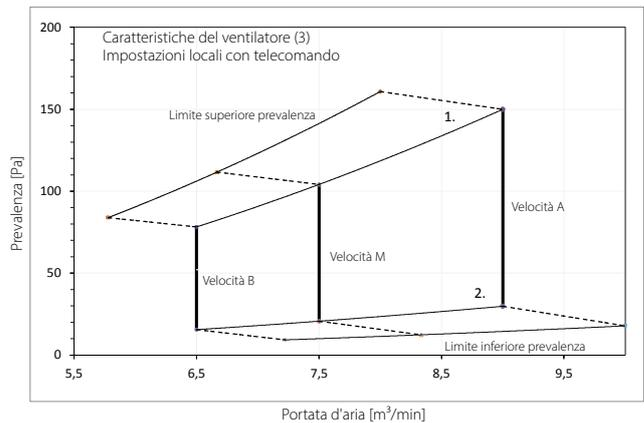
1. Limite superiore della prevalenza con regolazione automatica della portata d'aria
