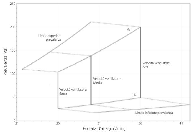
① Limite superiore della prevalenza con regolazione automatica della portata d'aria
