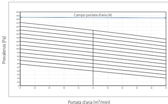
1. Limite superiore della prevalenza con regolazione automatica della portata d'aria
