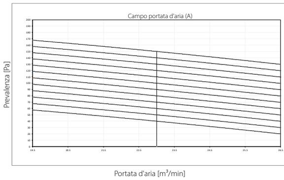
1. Limite superiore della prevalenza con regolazione automatica della portata d'aria
