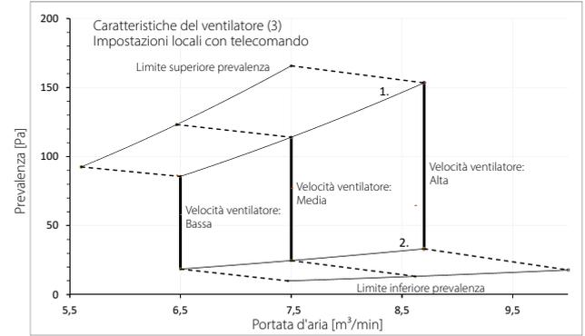
1. Limite superiore della prevalenza con regolazione automatica della portata d'aria
