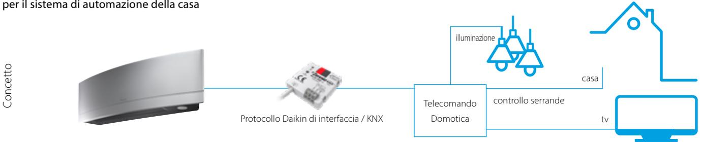
Collegamento di unità interne Sky Air / VRV all'interfaccia KNX per l'integrazione con i sistemi di gestione centralizzata degli edifici (BMS)
